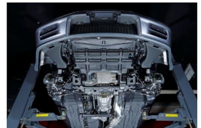
1. ボディ: 日産自動車の実績もベースにしたニスモ基準で「ホワイトボディねじり剛性測定」と「ボディ寸法測定」を含めた修復を行い、劣化値修正がされた良好なバランスを維持した総合的な性能を確認します。劣化したシーリングの再塗装付後、車体全てを希望色で再塗装します。(オプション: 電着塗装・メルシート交換)
