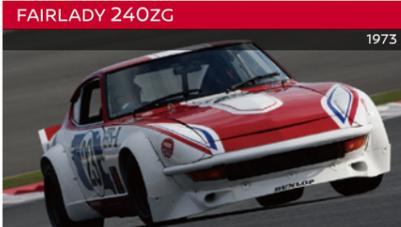
独自の「エアロダイナ・ノーズ」を持つ240ZGです。このクルマは240ZGのレース仕様テストカーで、排気量2,870ccクロスフローのLY28型エンジンを搭載していました。
