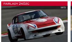
独特の「エアロダイナ・ノーズ」を持つ240ZGです。この クルマはその240ZGのレース仕様テストカーで、排気量 2,870ccクロスフローのLY28型エンジンを搭載してい ました。
