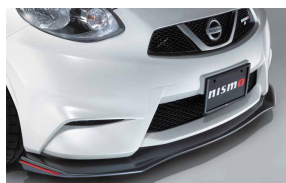
①フロントアンダースポイラー
