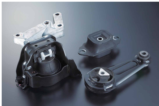
K13/E12用 左:フロント右、右上:フロント左、右下:トルクロッド
