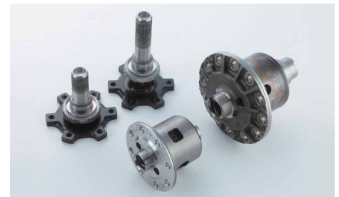
専用フロントL.S.D./専用リヤL.S.D.(カーボンプレート)
