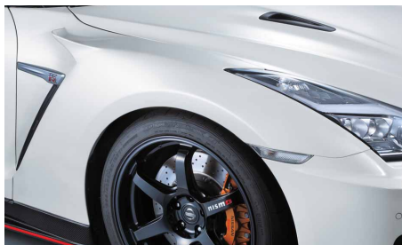
専用カーボンフロントフェンダー(ドライカーボン製、フリック付)
