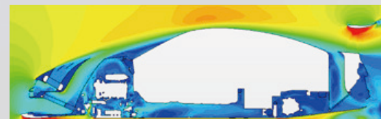
NISMO GT3 2018-Spec Aerodynamics ラジエーター、インタークーラーの配置を最適化するとともに、エンジンルームのエアフローを改善し、ドラッグを軽減。
