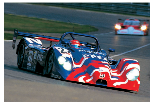
1999 | R391 クラスをLMP1へ切り替え、オープンボディのマシンを新規開発、NAエンジンを搭載したR391の熟成は途中で打ち切られた。
